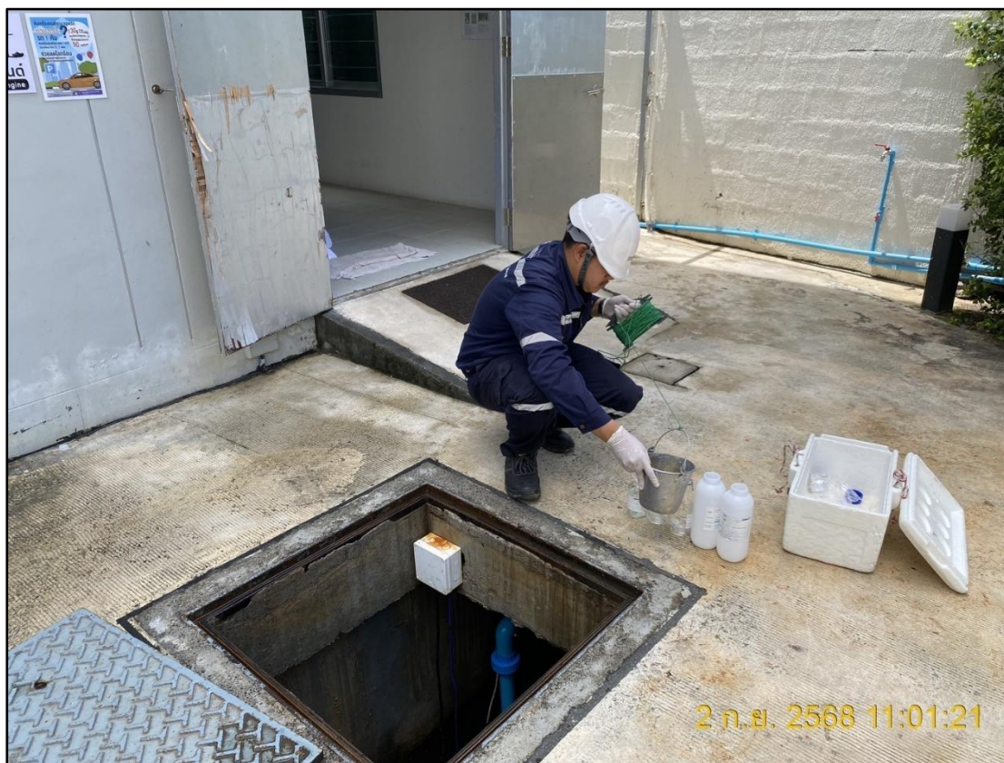
รูปที่ 3.1 จุดเก็บตัวอย่างน้ำทิ้งผ่านการบำบัด : จุดน้ำทิ้งบ่อสุดท้ายก่อนปล่อยสู่คลองสาธารณะ
